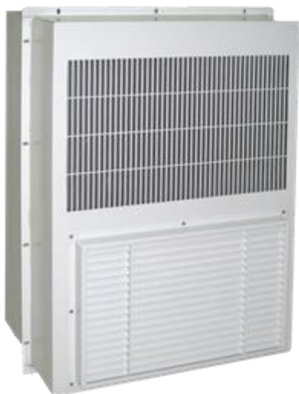
Термосифон постоянного тока Dantherm 150 предназначен для охлаждения шкафов и контейнеров с электронным оборудованием, чувствительным к температурному режиму. Термосифон реализует термодинамический метод пассивного охлаждения, основанный на естественной внутренней конвекции. В процессе работы хладагент циркулирует в вертикальном замкнутом контуре без помощи компрессора.
